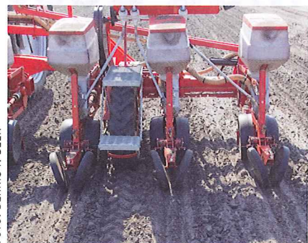
Actueel is gps-zaaien precies op de gleuven waar eerder via gps met dezelfde rijafstand drijfmest is geïnjecteerd.
