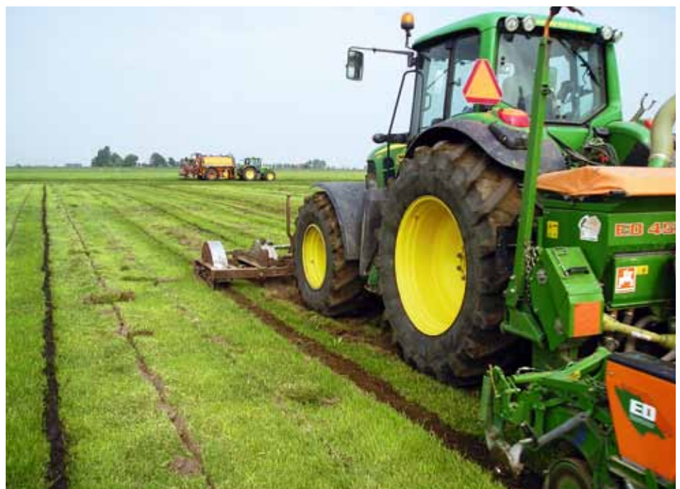
Het zaaien gebeurt met een combinatie van een frees in de fronthead en een zaaimachine achter de trekker.
