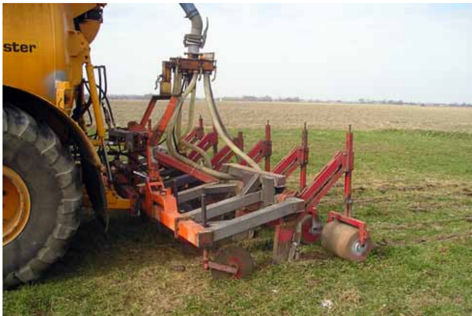
Met een graslandbeluchter wordt er bemest.
